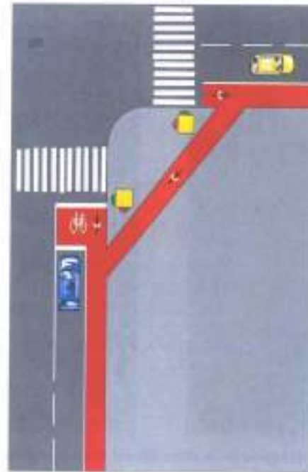
FIG IV.4-3: Atajo para el giro a la derecha
